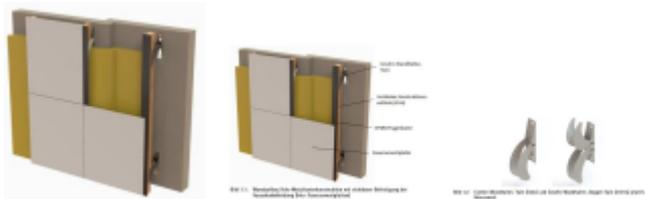
Holz-Unterkonstruktion für eine hinterlüftete Fassadenbekleidung nach DIN 18516-1, justierbar, zwängungsfrei liefern und montieren.
